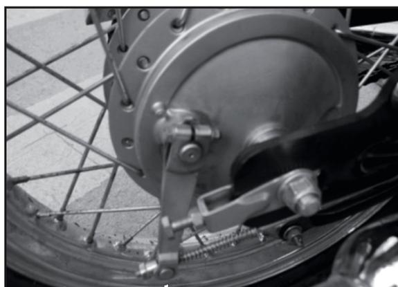
Dévisser l'écrou de l'axe de la roue arrière
