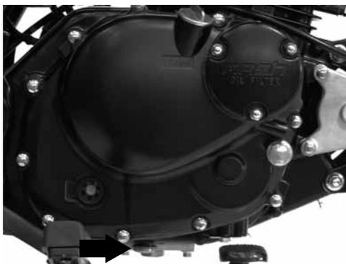
4. Serrer la vis de vidange et remplir le réservoir d'huile en y ajoutant environ 950 ml d'huile neuve, avant de resserrer doucement le bouchon supérieur.
