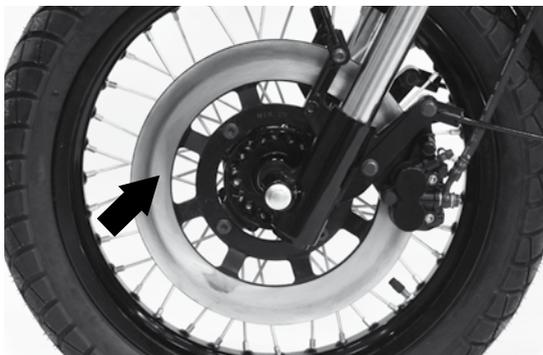
Le contrôle des garnitures se limite pour l'essentiel à la vérification de leur état d'usure par comparaison de leur épaisseur avec la rainure formant repère. La garniture doit être remplacée si elle est usée jusqu'au fond de la rainure.
