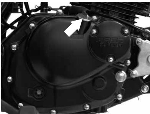
3. Retirer le bouchon de vidange du couvercle de la crépine (en dessous du moteur) pour effectuer la vidange.
