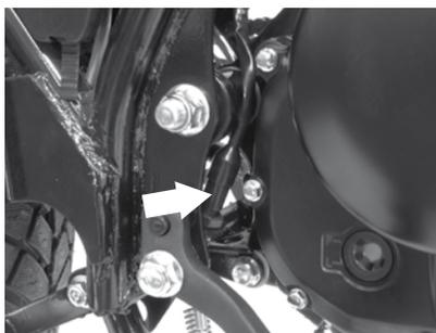
Le contacteur du feu stop arrière se situe sur le côté droit de la motocyclette. Pour régler le contacteur du feu stop arrière, procéder comme suit : Soulever ou abaisser le contacteur de sorte que le feu s'allume à la moindre pression sur la pédale de frein.
